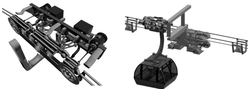
Рис. 3. Мехатронные модули движения дискретного привода канатного метро
