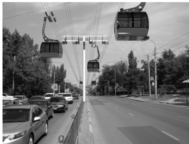
Рис. 1. Компьютерная модель промежуточных опор и подвижного состава канатного метро, интегрированного в урбанистику
